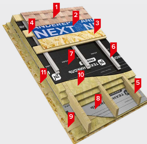
КОНСТРУКЦИЯ СОВМЕЩЕННОГО ЧЕРДАКА (МАНСАРДЫ)
